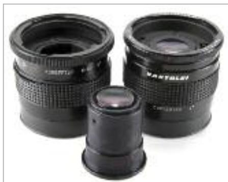
**Zu sehen sind der Arsenal K-6b 2x-Konverter (links) und sein Hartblei Spinoff (rechts). Dem Arsenal-Konverter können die optischen Elemente entnommen werden. Der restliche Tubus ist dann als Zwischenring verwendbar.**
