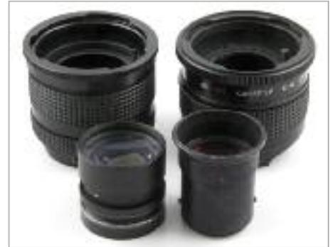
**Oben: Bei diesem Konverter (links) scheint es sich um einen extrem gut gemachten Eigenbau zu handeln. Der Tubus besteht aus Teilen des PENTACON six Zwischenringsatzes. Sie sind so passgenau gefügt, dass es erscheint, der Tubus sei aus dem Vollen gedreht. Auch die Optik ist sehr aufwändig. Leider ist nicht zu erkennen, aus welchem Konverter sie stammt. Die Optik (zum Vergleich ausgebaut) ist nicht entnehmbar wie etwa bei dem K-6b von Arsenal (rechts).**
