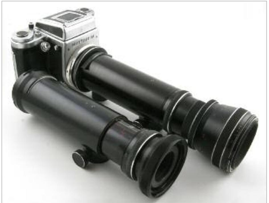
**Dieser ungewöhnliche Konverter von Kilfitt lässt sich gleich von 2x bis 4x in insgesamt fünf Stufen variieren! Der Fotograf muss in Kauf nehmen, dass es keinen Druckblendenstift gibt und dass das Bild im Lichtschacht nicht nur seitenverkehrt ist sondern auch noch auf dem Kopf steht.**
