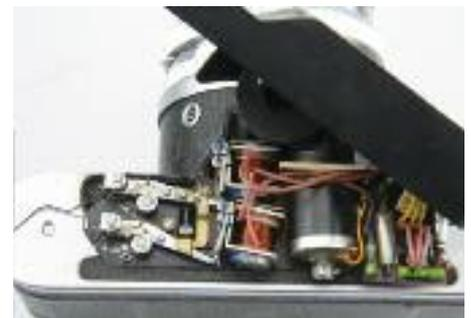
Möglicherweise ist diese Versuchskamera die erste Spiegelreflexkamera mit elektronisch gesteuertem Verschluss gewesen. Der Anbau an der Unterseite enthält neben dem Batteriefach und dem Fotowiderstand zwei Elektromagneten und die Ansteuerungselektronik. Der Selbstauslöser musste einer inneren Mechanik weichen. Als reiner Zeitautomat entfällt auch die Funktion des Zeitenrades, welches durch eine unbeschriftete Blende ersetzt wurde.
