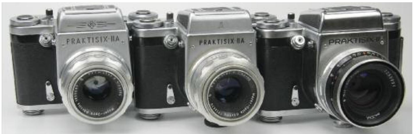
Dreimal Praktisix IIA. Der Prototyp (links, 34101, V1580) gleicht mit Ausnahme weniger Details der Serienkamera (rechts). Bei der Kamera daneben (mittig, 39480) scheint es sich um eine Vorserienkamera zu handeln. Die Schriftzüge beider Kameras differieren vom Serienmodell (rechts, etwa 40000-44000).
