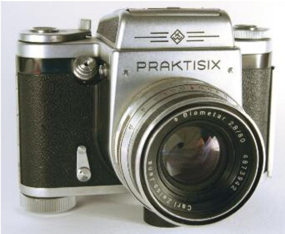
**Extra für diese Versuchskamera wurde eine neue Form erstellt. Die Filmbühne ist nicht etwa maskiert sondern schon von vornherein für das Format 4,5x6 gefertigt. Das Zählwerk und der Filmtransport wurden allerdings nicht an das neue Format angepasst. Vielmehr wurde die Kupplung zum Aufzug aufgehoben. Stattdessen muss der Film über den großen gerändelten Knopf an der Unterseite transportiert werden. Das rote Fenster in der Rückwand ermöglicht die Kontrolle des Filmschrittes.**
