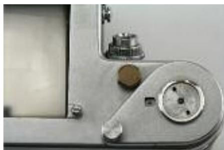
**Bei dieser Versuchskamera aus der ersten Baureihe der Praktisix wurde erstmals der Aufzugsanschlag eingesetzt, wie er kurz darauf auch in Serie ging. Wie hier, wurden neue Teile an Versuchskameras häufig in nichteloxiertem Zustand verbaut.**
