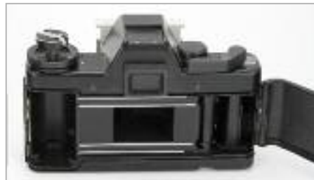
Nachdem die Werra Mitte der Achtziger nicht mehr verfügbar war, wurden auch andere Kleinbildkameras als Basis für Filmkassetten verwendet. Anders als bei der PENTACON six M handelt es sich aber nicht um modifizierte Kameras sondern von vornherein für die Aufgabe geschaffene Geräte. Bei der B100 M sind infolgedessen Spiegel, Prisma, Zeitenwerk, Verschluss und Zubehörschuh nie montiert worden. Es sind nur die Teile vorhanden, die für den Filmtransport benötigt werden. Filmkassetten wurden auch auf Basis weiterer Kleinbildkameras entworfen.
