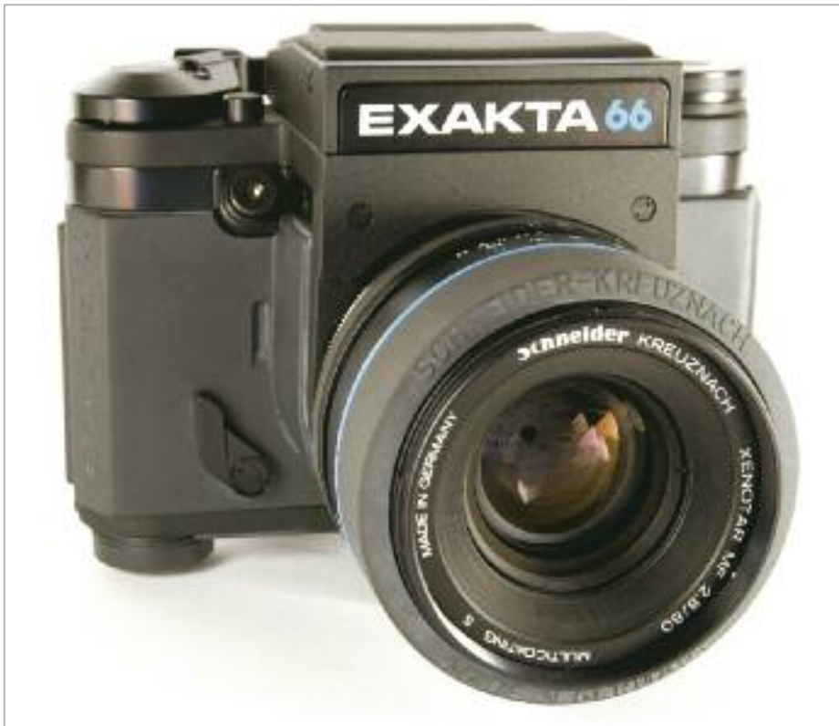
Das TTL-Prisma der Exakta 66 ließ eine gekuppelte Messung zu. Ein kleiner Stift teilte dem Prisma die maximale Blendenöffnung mit, ein beweglicher Nocken die eingestellte Arbeitsblende.
