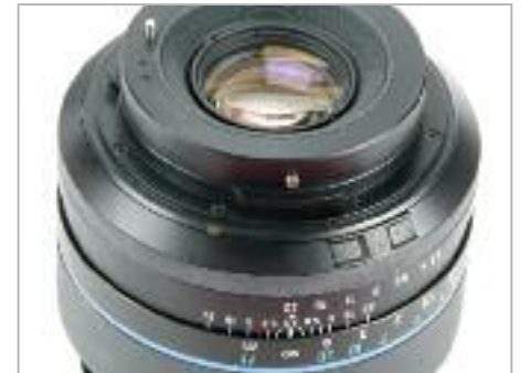
Das TTL-Prisma der Exakta 66 ließ eine gekuppelte Messung zu. Ein kleiner Stift teilte dem Prisma die maximale Blendenöffnung mit, ein beweglicher Nocken die eingestellte Arbeitsblende.
